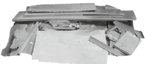
Der zweitgrößte Bestandteil ist Karton. Die Ummantelung dient als Armierung und verleiht den Platten die erforderliche Festigkeit und Biegesteifigkeit.
