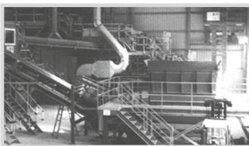
Im Brecher-System erfolgt dann beim Flachglas die Abschlagung des Glases von der Folie, bzw. wird beim Drahtglas Glas und Draht getrennt.
